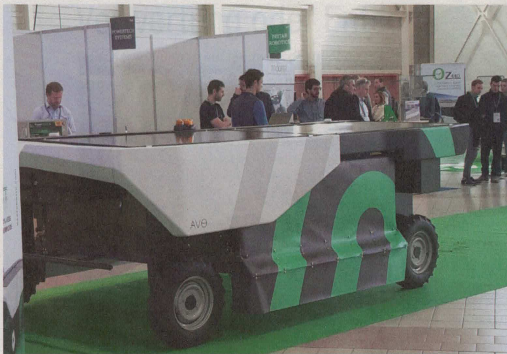
AVO nennt sich der Unkrautroboter der Firma ecoRobotix aus der Schweiz, der mit solaren Modulen betrieben wird. Foto: ecoRobotix
