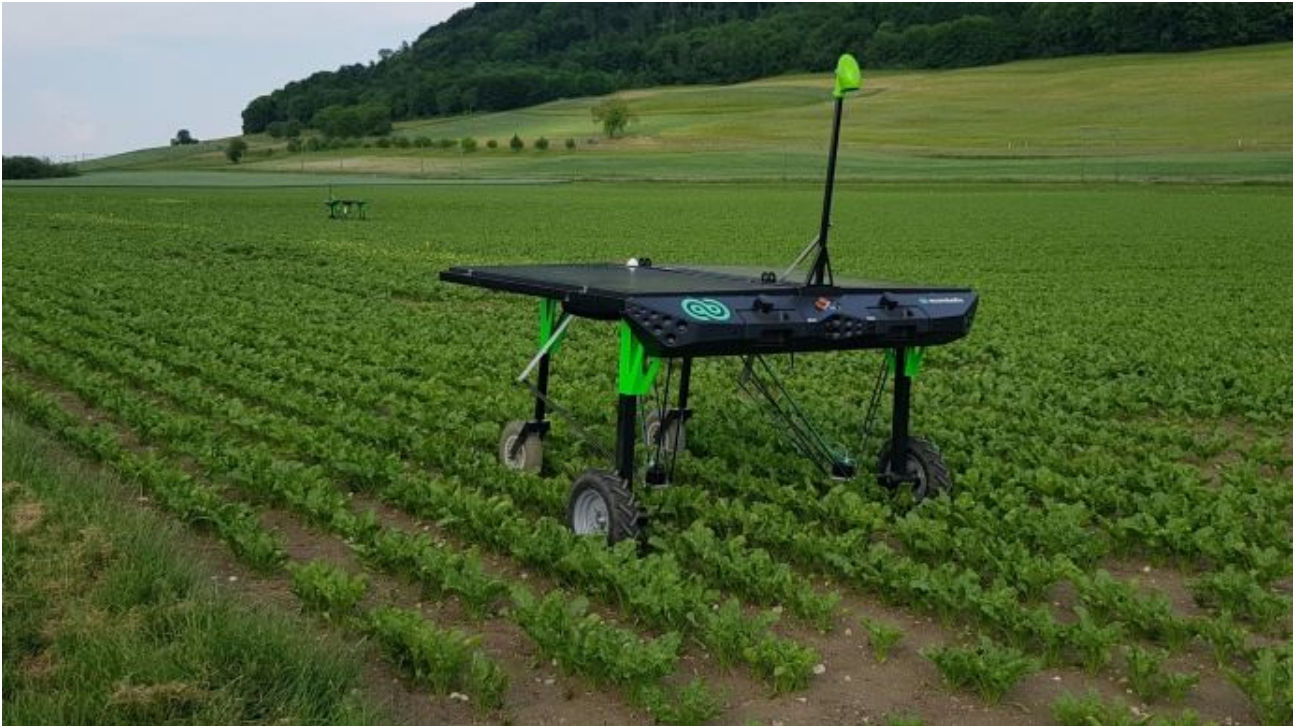
Le robot de désherbage Ecorobotix est testé en grandes cultures. (©Ecorobotix)
