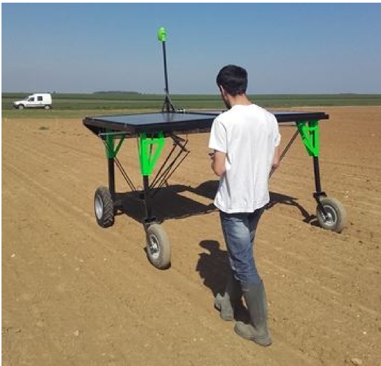
Ecorobotix désherbe par pulvérisation et fonctionne à l'énergie solaire. (©Chambre d'agriculture du Loiret)
