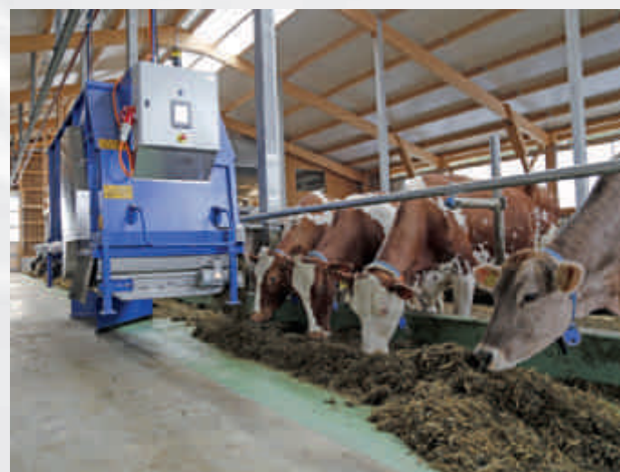
Der Bauer muss mit dem Roboter nur noch die Futterkomponenten in den Mischer füllen. Den Rest erledigt die Maschine.
