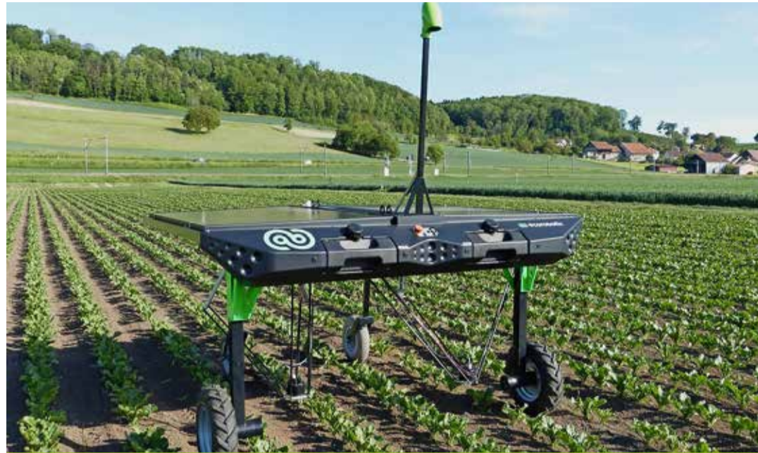
Le robot désherbeur conçu à Yverdon se déplace sur les champs. Il reconnaît les plantes avec sa caméra et élimine les mauvaises herbes de manière ciblée. FONDATION SUISSE POUR LE CLIMAT
