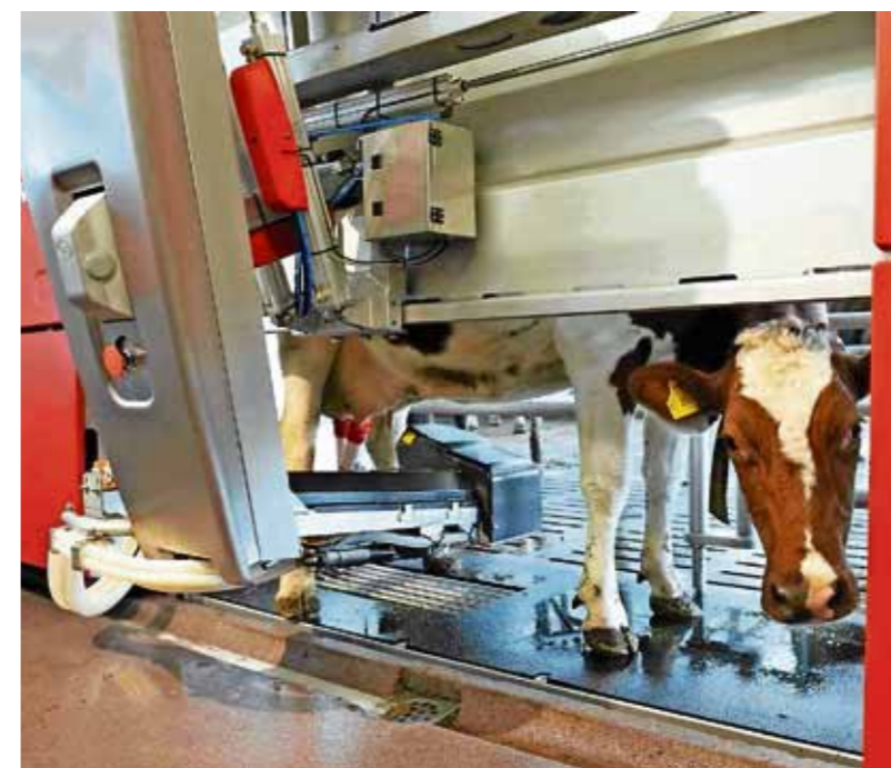
EFFICIENTE E VELOCE Uno dei più recenti robot per la mungitura del bestiame.
