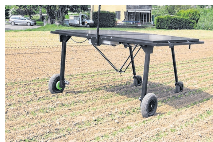
Un bras articulé permet au robot de désherber mécaniquement ou avec une microdose d'herbicide. C. KÜNDIG
